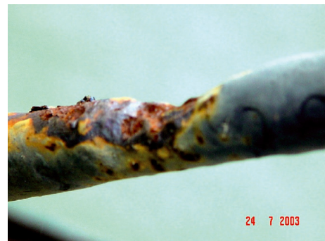
Fig. 10. Zone de corrosion localisée sur un fil.
