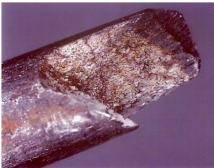
Fig. 13. Faciès de rupture semi-fragile sans réduction de section.
