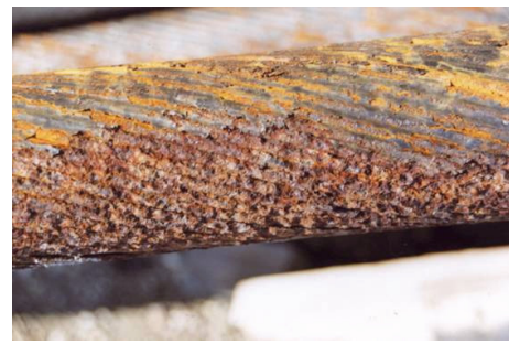
Fig. 9. Zone de dissolution sur un multicouche.
