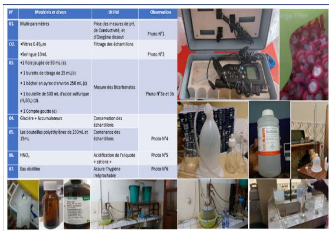
Figure 6 : Equipements de mesure et conservation des échantillons hydrochimiques.
